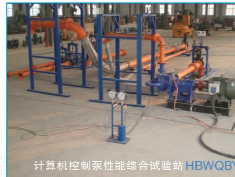
计算机控制泵性能综合试验站 HBWQBY
